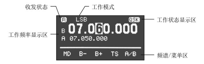
NOTE:收发状态: Transmission status;工作模式: Operating mode: 工作频率显示区: Working frequency display area;工作状态显示区: Work status display area;频谱/菜单区: Spectrum / menu area
