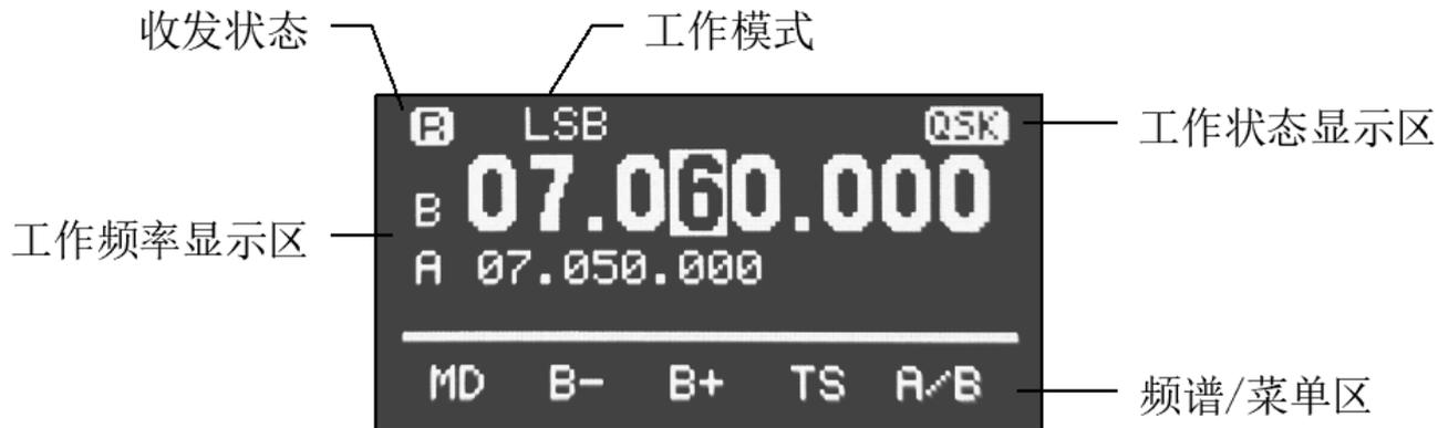
NOTE: 收发状态: Transmission status; 工作模式: Operating mode; 工作频率显示区: Working frequency display area; 工作状态显示区: Work status display area; 频谱 / 菜单区: Spectrum / menu area
